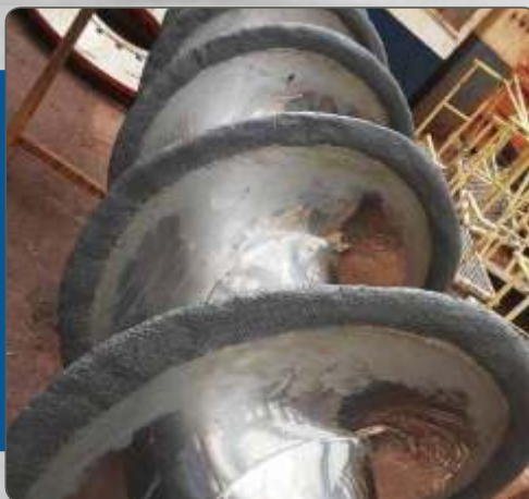
RECUPERAÇÃO DE ROSCA TRANSPORTADORA
